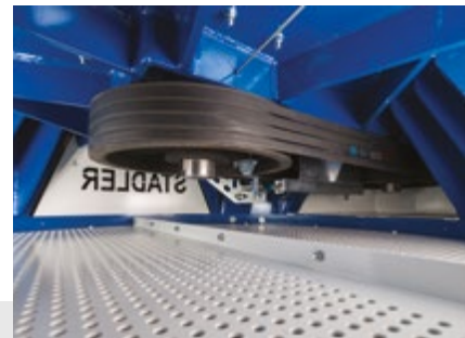
Accionamiento por correa con rodillo tensor
