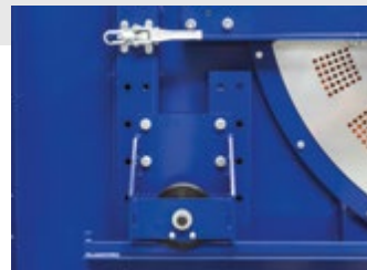
Ajuste de la altura del tambor
