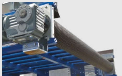
Motores con reductor adosado de engranajes cónicos
