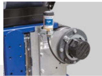
Cartucho de grasa para lubricación permanente
