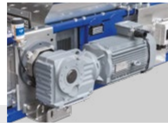
Motor impulsor con interruptor de mantenimiento
